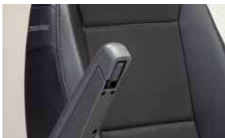
Regolazione braccioli a scomparsa da -15° a +90° partendo dalla posizione orizzontale di appoggio. Flip up armrests from -15° to +90° starting from horizontal position.
